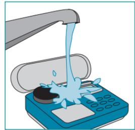
Figure 5-1 Rinçage de la pompe sous un jet d'eau
